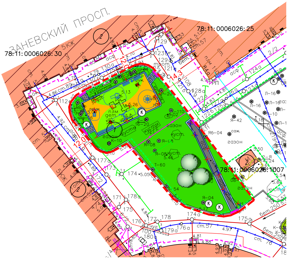
СХЕМА БЛАГОУСТРОЙСТВА ОБЪЕКТА БЛАГОУСТРОЙСТВА М 1:500
